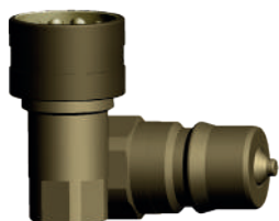
SERIE B ISO 7241/B LATON Y JUNTA VITÓN ROSCA BSPP B SERIES ISO 7241/B BRASS AND VITON O-RINGS BSPP THREAD SÉRIE B ISO 7241/B LAITON ET JOINT VITON FILETAGE BSPP
