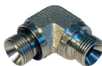
CODO 90° MACHO FIJO MACHO FIJO BSPP (CIERRE POR 60° O POR JUNTA METALGOMA) 90° ELBOW BSPP STUD MALE-STUD MALE (TIGHTNESS BY 60° CONE OR CAPTIVE SEAL) COUDE 90° MÂLE FIXE MÂLE FIXE BSPP (FERMETURE CÔNE OU BAGUE BS)
