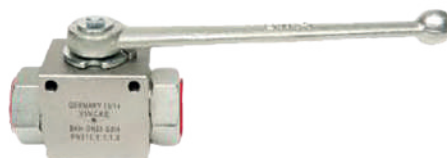
2 VIAS SERIE BKH ROSCA BSPP CON TALADROS CON BOLA INOXIDABLE 2-WAY SERIES BKH BSPP THREAD WITH HOLES STAINLESS STEEL BALL 2 VOIES SÉRIE BKH FILETAGE BSPP AVEC TROUS BOULE INOXYDABLE
